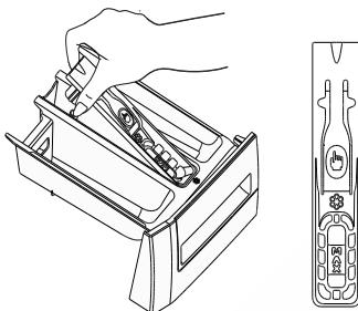
Поднимите заднюю часть сифона, чтобы его вынуть, как показано на рисунке.
