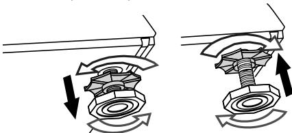
3. Затем вручную затяните все контргайки.
